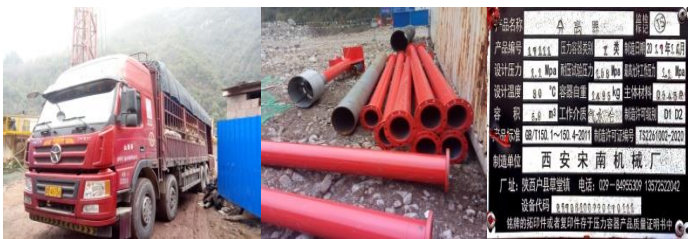
图 1:新到井钻井液材料 20 吨 2:气体处置装置已备齐 3:液气分离器铭牌
